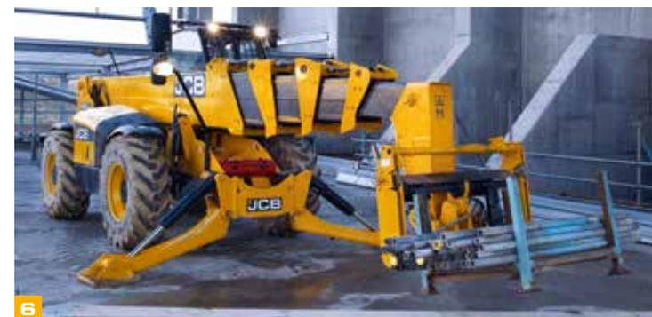
El Control de carga adaptable JCB controla automáticamente el funcionamiento del sistema hidráulico para ayudar a mantener la estabilidad longitudinal del 540-200.
