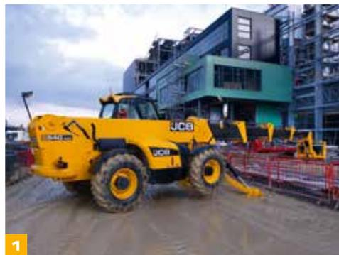
El 540-200 Loadall ofrece tiempos de ciclo rápidos gracias a su sistema de servomandos electrohidráulicos y su bomba hidráulica de alto caudal de 110 l/min. Disfrutará de un manejo rápido y productivo de cargas suspendidas.
