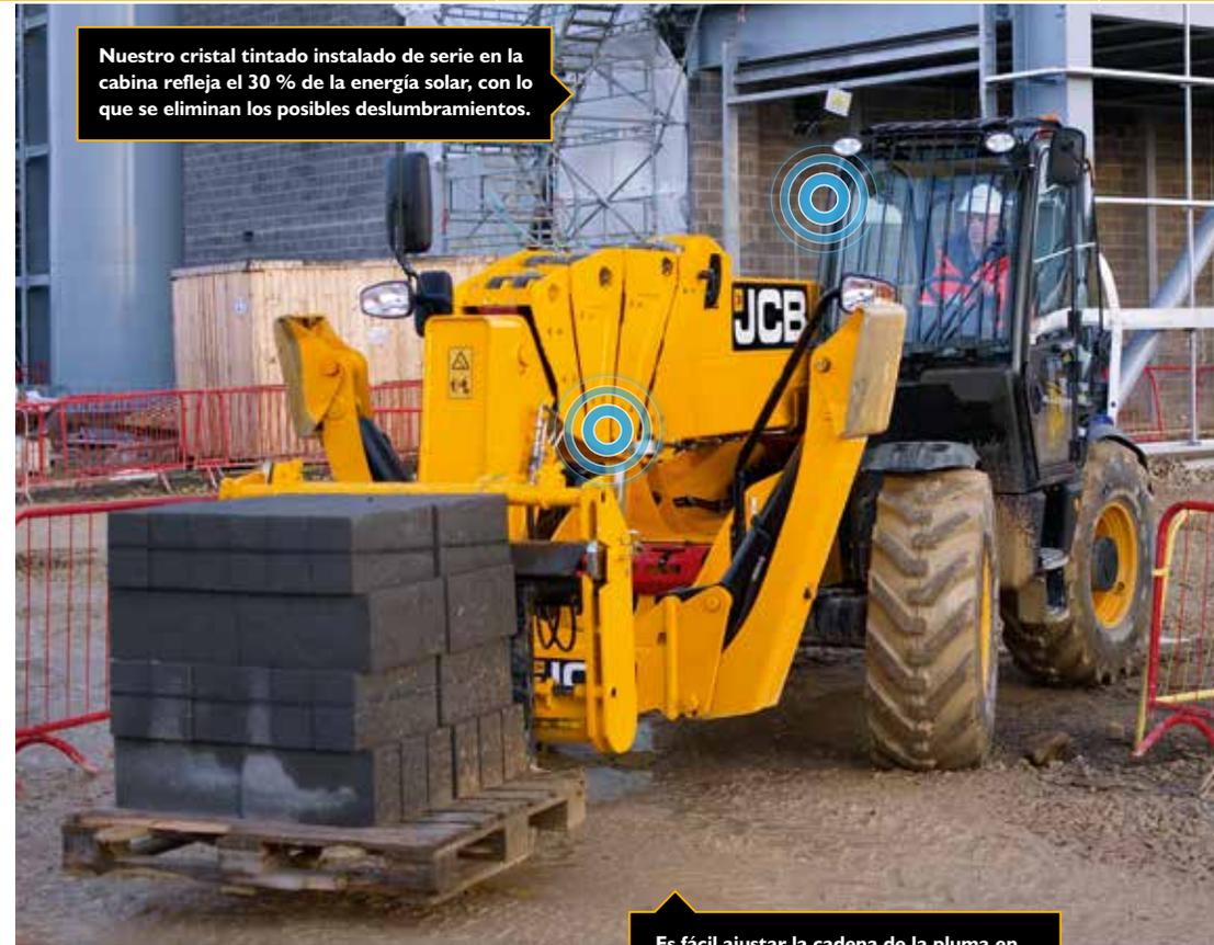
Nuestro cristal tintado instalado de serie en la cabina refleja el 30 % de la energía solar, con lo que se eliminan los posibles deslumbramientos.
