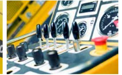
El sistema de control hidráulico piloto proporciona al operador un control total. La estación del operador funciona a una presión hidráulica reducida (máx. 50 bar), lo que significa que es más seguro para el operador y más liviano.
