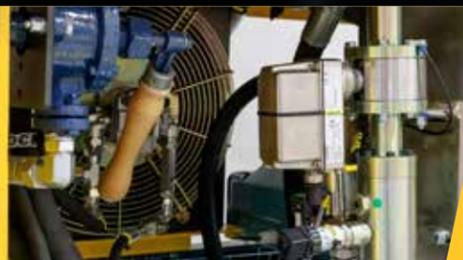
Un medidor de flujo de agua inductivo, sin partes móviles, y un sensor de presión altamente preciso aumentan la confiabilidad de barrido y la disponibilidad de la máquina.
