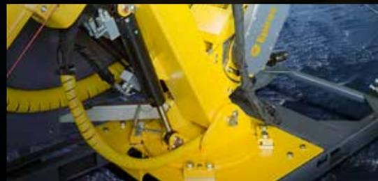
La tornamesa y el brazo de posicionamiento combinados únicos en el Diamec PHC 4 y 6 permiten una configuración fácil, rápida y precisa.
