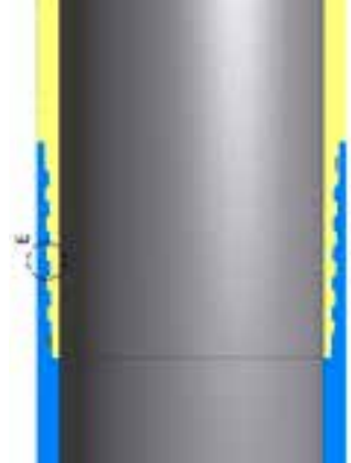
Perfil de rosca de barras ATW, BTW y NTW.
